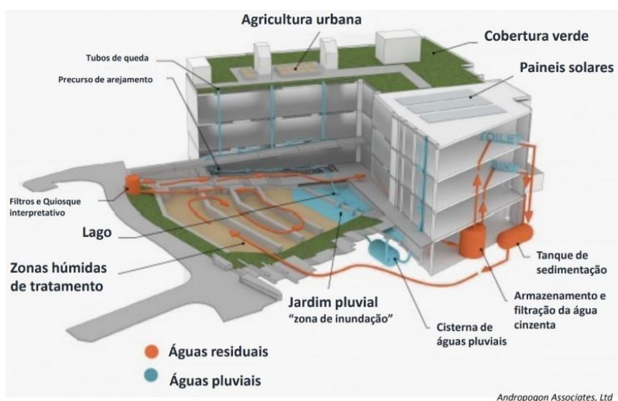
Fig. 2 O sistema de reutilização de água da Sidwell Friends School da Andropogon Associates, Kieran Timberlake Associates e Natural Systems International. Imagem da Andropogon Associates.
